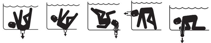
LA BOMBA PRODUCE ALTOS NIVELES DE SUCCIÓN Y CREA UN FUERTE VACÍO EN EL DRENAJE PRINCIPAL EN LA BASE DEL CUERPO DE AGUA. ESTA SUCCIÓN ES TAN FUERTE QUE PUEDE ATRAPAR A ADULTOS O NIÑOS DEBAJO DEL AGUA SI SE ACERCAN DEMASIADO AL DRENAJE O SI HAY ALGUNA PARTE DE LA CUBIERTA O PARRILLA DEL DRENAJE SUELTA O AVERIADA.
