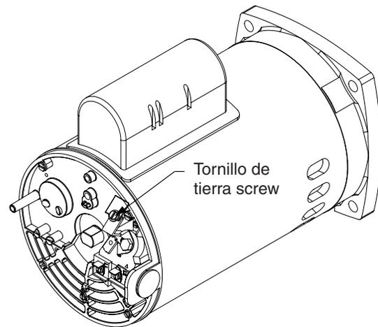
**Nota:** Cuando la bomba se monta permanentemente dentro de 5 pies (1.524 m) de las paredes interiores de una piscina, tiene que usar un No. 8 AWG o conductor más grande para conectar al tirón de conductor que pega.
