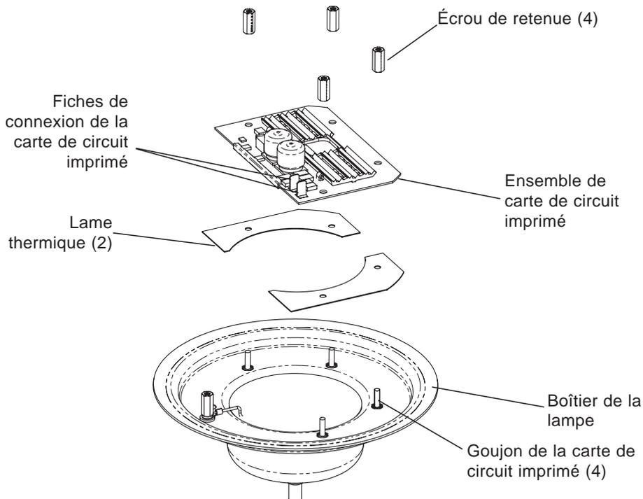
1. Placez les deux lames thermiques (fournies) sur les goujons de la carte de circuit imprimé dans la base du boîtier de la lampe (consultez l'illustration à la page suivante).
