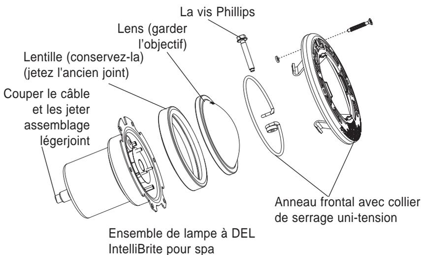
7. **INSTALLATION DE LA LAMPE À DEL INTELLIBRITE 5G POUR SPA AVEC UN JOINT NEUF :** Installez un joint neuf lors du remontage de la lampe à DEL IntelliBrite 5G pour spa. UN JOINT NEUF POUR LENTILLE DOIT ÊTRE UTILISÉ À CHAQUE REMONTAGE DE LA LAMPE.
