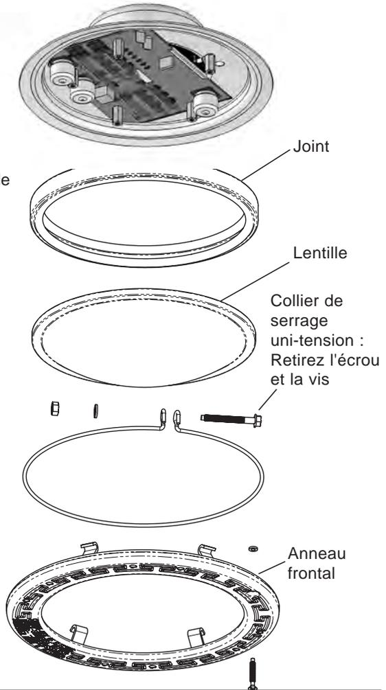
**Remarque : UN JOINT NEUF (PIÈCE N° 79101600) DOIT ÊTRE UTILISÉ À CHAQUE REMONTAGE DE LA LAMPE. Consultez la page 15, pour le numéro de pièce des nécessaires de rechange.**
