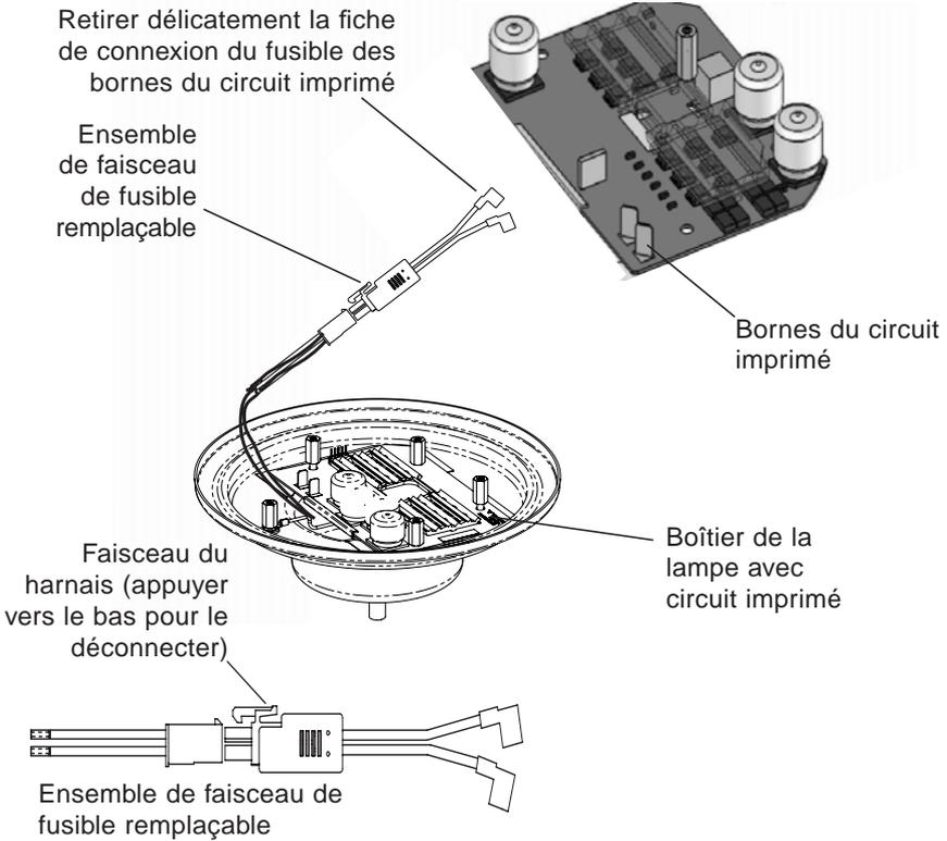
1. Avec vos doigts, débranchez soigneusement chaque fiche de connexion du fusible des bornes du circuit imprimé. Soulevez délicatement chaque fiche avec de petits mouvements latéraux, tout en maintenant en place les bornes du circuit imprimé avec un tournevis plat. Par la suite, débranchez progressivement la fiche de connexion de la borne. *Remarque : Pour éviter des dommages permanents au circuit imprimé, veillez à ne pas arracher les bornes de la surface du circuit imprimé.*
