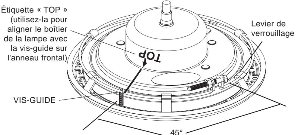
Positionnez le collier de serrage (écrou et boulon) à environ 45° entre la VIS-GUIDE et le LEVIER DE VERROUILLAGE
